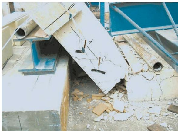
Fig. 8 - Pannello n. 3 con laterizi Cat. A allineati.
